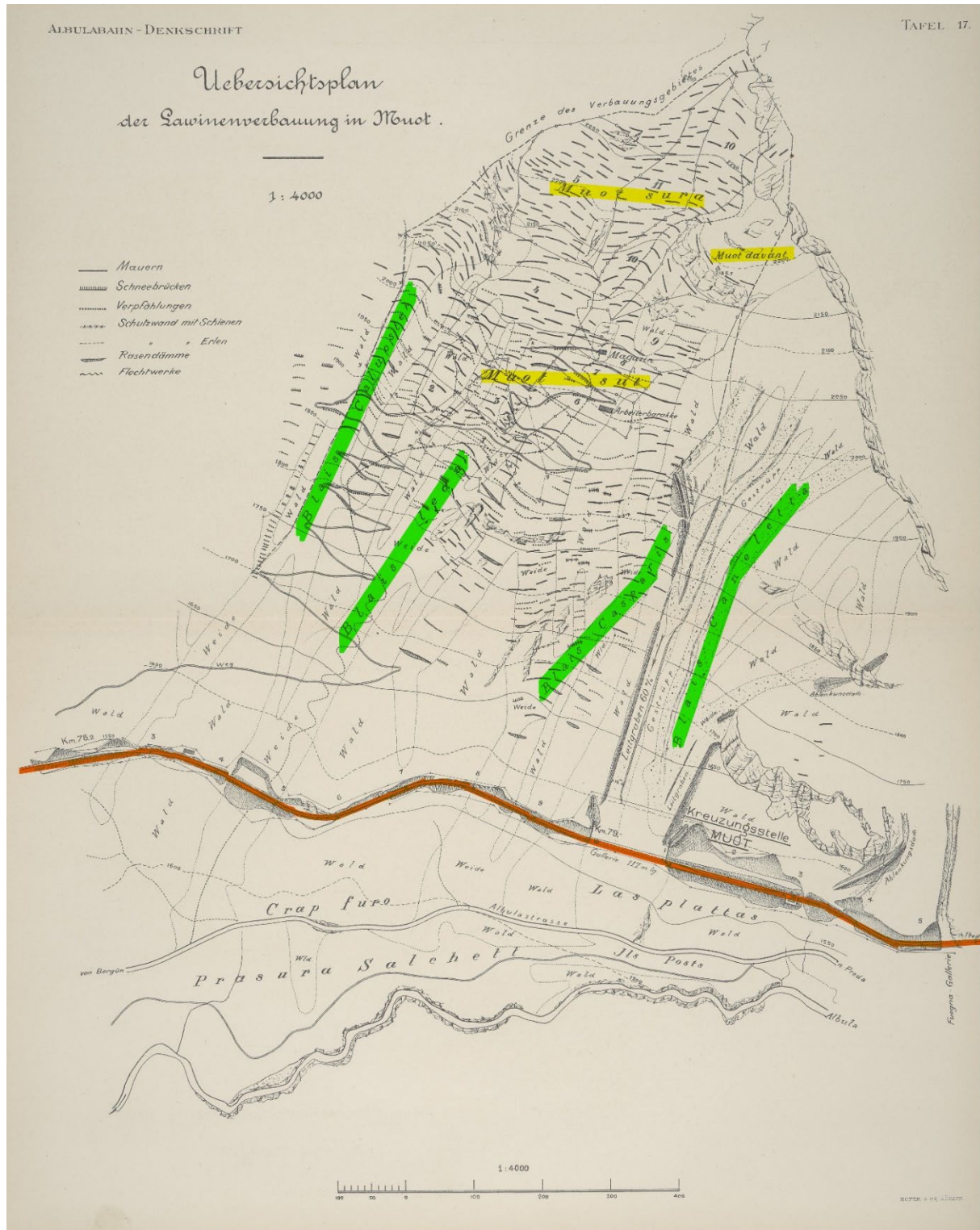
Abb. 9: Übersichtsplan der Lawinerverbauung Muot nach Hennings 1908 im Masstab 1:4'000. Quelle: Hennings 1908: Tafel 17. Durch den Verfasser wurden Muot sura, Muot davant sowie Muot sut gelb gekennzeichnet. Von Norden nach Süden sind die Blais Caluoster, Blais Leda, Blais Casparis sowie Blais Caneletta grün hervorgehoben. In Nord-Südrichtung verläuft ausserdem die rot markierte Bahnstrecke. Für eine Variante ohne Markierung vgl. Abb. 29 im Anhang.
